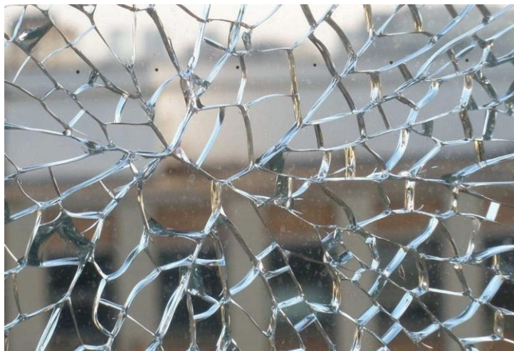
Obrázok č. 1 - Samovoľný lom bezpečnostného skla tepelne tvrdeného
